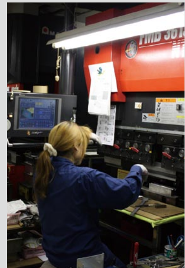
女性社員もFMB-3613NTを使って曲げ加工を行っている。
